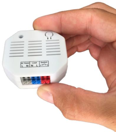
Der smarte Schaltgehilfe für Zuhause: Das LUPUS 2 Kanal Relais mit ZigBee Repeater.
